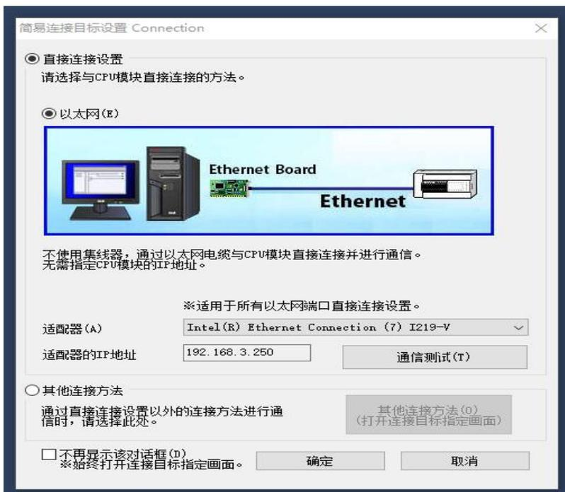
将PC的网络地址更改和PLC, 模块同网段的地址, 点击通信测试测试PC和PLC之间的通信, 通信成功之后点击主菜单栏的转换按钮->全部转换->确定, 然后点击主菜单栏在线->写入至可编程控制器(W), 下载网络配置和参数到PLC中, 然后点击主菜单栏的监视开始按钮, 开始在线监视。点击主菜单栏的在线->监视->软元件/缓冲存储器批量监视(B), 如下图所示:
