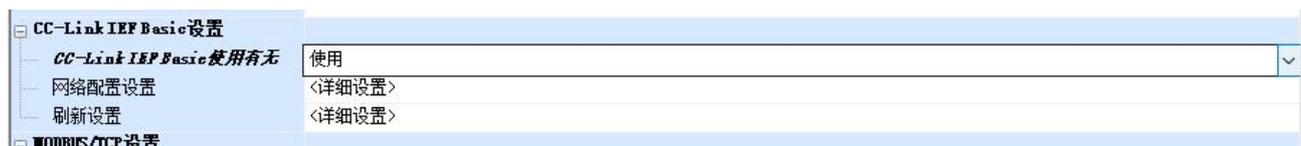
在CC-Link IEF Basic设置菜单下，点击网络配置设置菜单的详细设置，弹出网络配置窗口，如下图：
