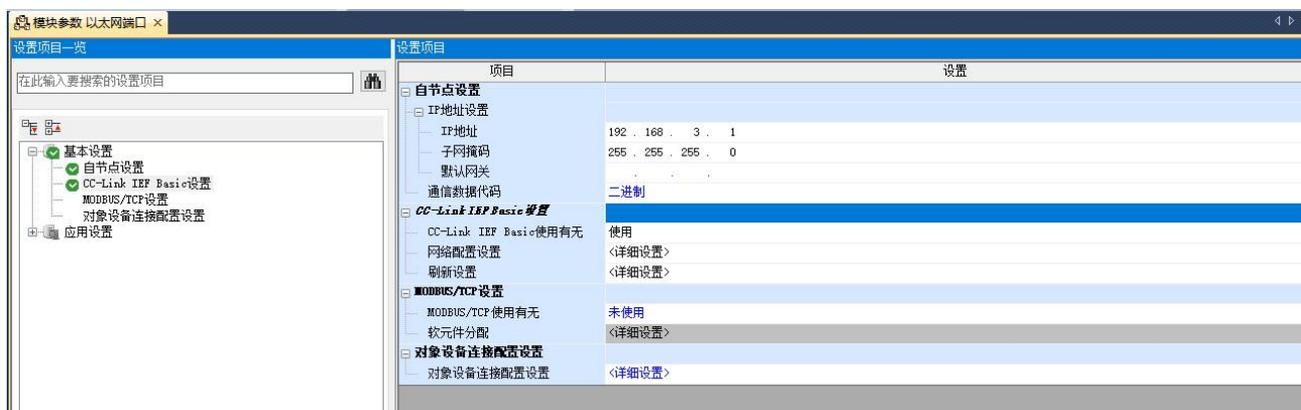
在CC-Link IEF Basic设置菜单，CC-Link IEF Basic使用有无的下拉菜单里面选择使用，如下图所示
